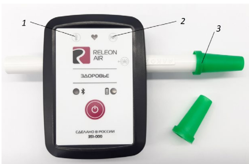
Рис. 2. Мультидатчик по физиологии: 1 — температура тела, 2 — пульс, 3 — частота дыхания (надет съёмный мундштук)
